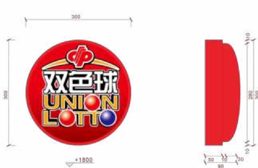
靠墙安装吸塑灯箱尺寸图（单面发光）
