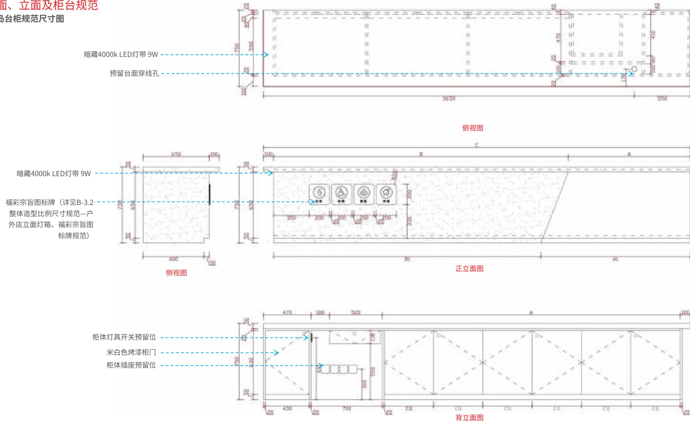
**规范说明:** 图中尺寸标注为数字时, 为定值不可变更。A、A1、B、B1为岛台柜正立面红白分色相交分割线, A: A1=3:1, B: B1=2.5:1, C为柜体总长, C取值范围=4500~2400mm。EQ为等分数值。在实际应用中根据现场尺寸调整整体柜体长度。
