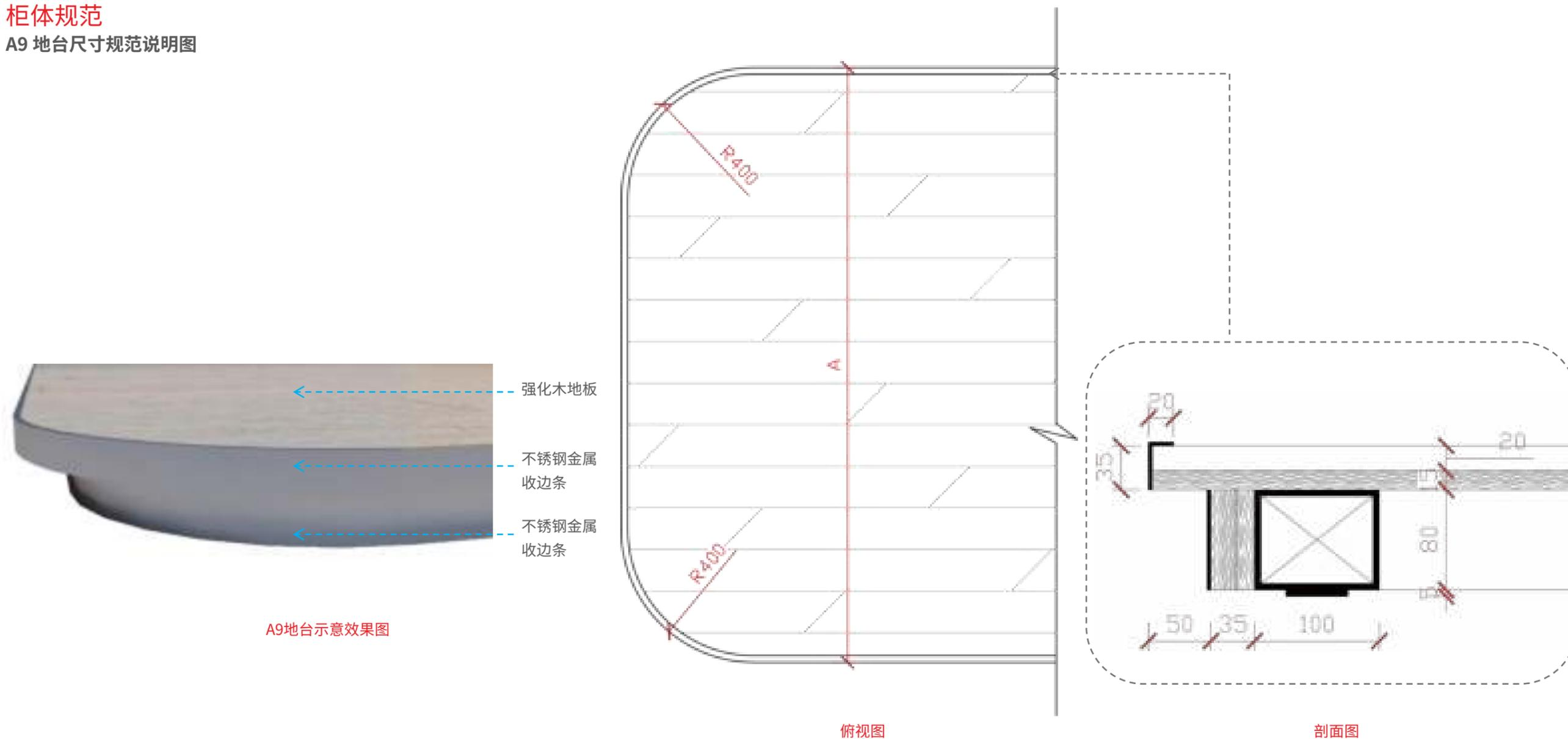
**规范说明:** 图中尺寸标注为数字时, 为定值不可变更。地台宽度A取值范围随岛型店整体长宽变动, 地台工艺尺寸详见(上图)剖面图; 地台为选配项, 当现场实际情况不具备地台的施工要求时, 可取消地台, 店面内所需的供电线路可在柜台底部空间进行隐藏敷设。
