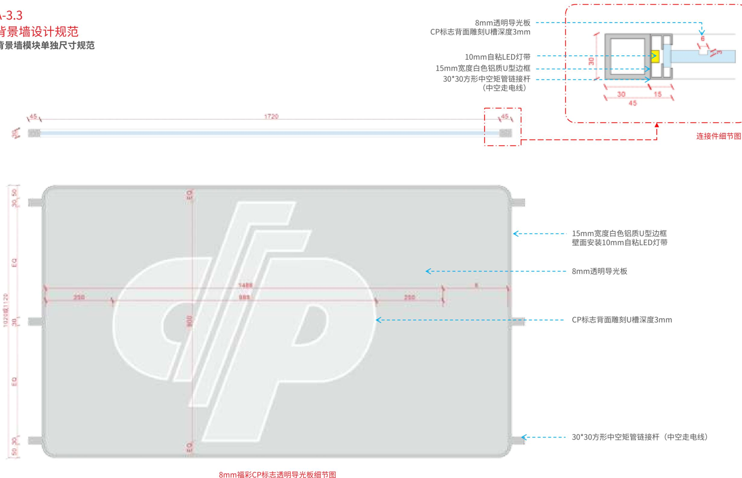
规范说明：导光板为“X”处尺寸可随现场尺寸自由增减，导光板版面总宽度不能超过3000mm，最低宽度不能小于1500mm，表现数值的为定值不可更改。EQ为等分数值。
