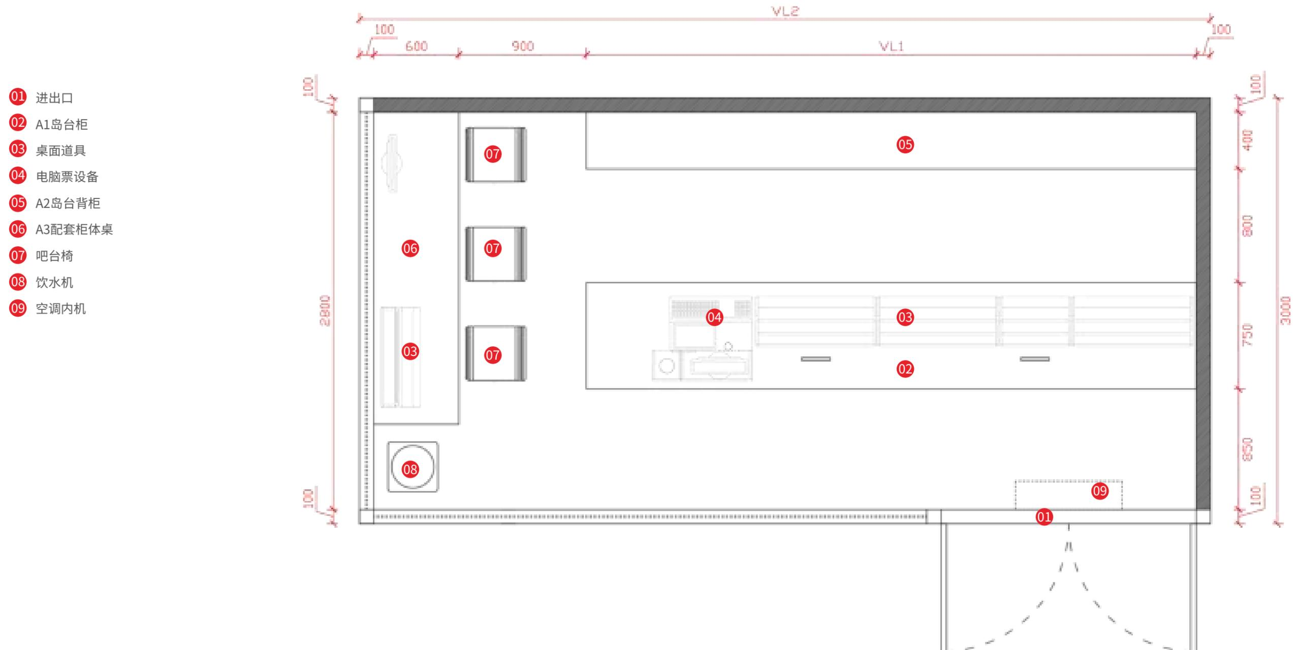
**规范说明:** VL1为岛台长度, 取值范围 (2400mm≤VL1≤4500mm); VL2整体长度, 取值范围 (4100mm≤VL2≤6500mm); 在实际应用中, 可根据实际尺寸在满足人体工程学及实用情况下对相关尺寸等比增减, 功能模块按需选配。
