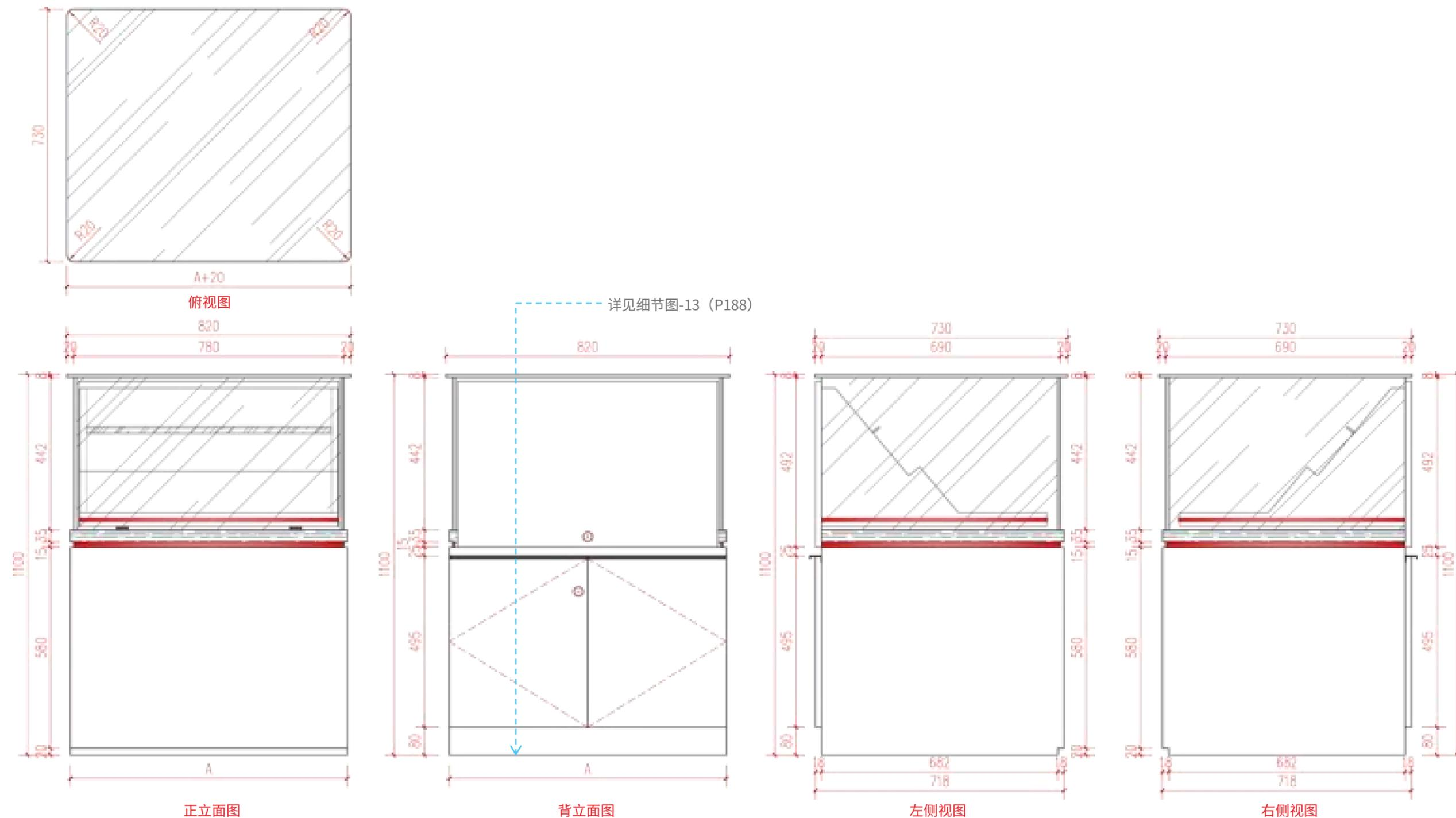
规范说明：图中尺寸标注为数字时，为定值不可变更。A可取值为700mm或1000mm，细节图详见B-6.4P平面、立面及柜台规范-A4即开票玻璃柜细节图（细节图-13）。
